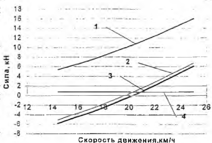
Рисунок 1.4 – Залежність необхідних зусиль на ЗП від швидкості руху (для радіуса повороту 15 м) [89]: 1 – сила інерції; 2 – необхідне тягове зусилля на ЗП; 3 – необхідне додаткове зусилля; 4 – сила опору руху причепи.
