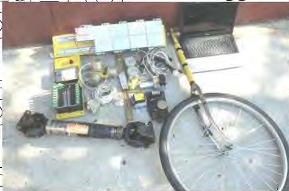
Рисунок 4.4 – Вимірвальний комплекс апаратури для визначення характеристик транспортних засобів: 1 – вимірвальний комплекс із програмним забезпеченням на базі ноутбука; 2 – модуль ЦАП-ЦАП з гальванічною розв’язкою, каналами цифрового введення – виведення; 3 – модем дистанційного передавання даних; 4 – карданний вал із тензомостом та інформаційним передавальним модулем; 5 – тахометр із датчиком обертів маховика; 6 – плата швидкості руху і переміщення; 7 – витратомір палива; 8 – вібродатчики; 9 – датчик лінійних переміщень; 10 – “п’яте” колесо із герконовим датчиком обертів; 11 – блоки живлення датчиків; 12 – акселерометр
