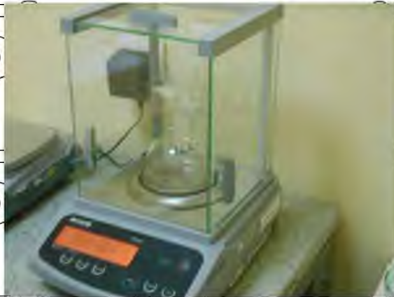
Рис. 3.2 - Електронні ваги в процесі зважування проби
