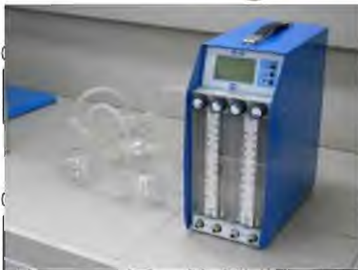
Рис. 3.1 - Загальний вигляд установки для оцінки кількості палива втраченого при заправці автомобіля
