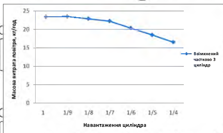
Рис. 4.34. Графік залежності масової витрати від навантаження циліндра при частково включеному третьому циліндрі
