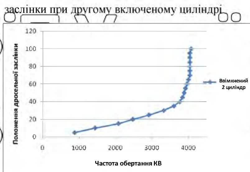
Рис. 4.17. Графік залежності положення дросельної заслінки від частоти обертання КВ при другому включеному циліндрі
