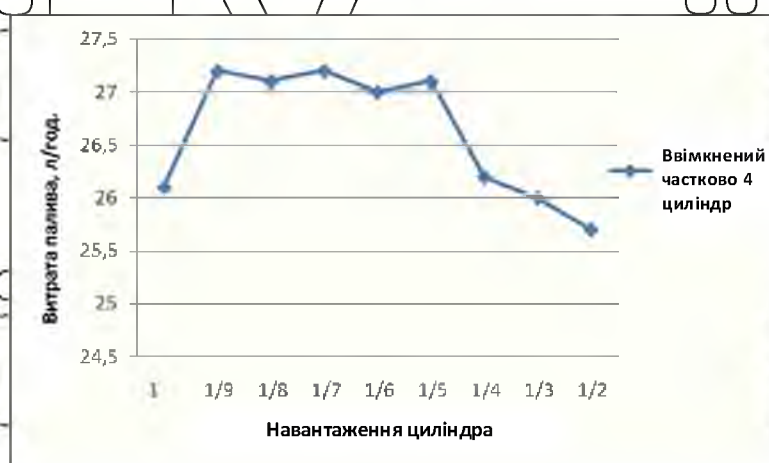
Рис. 4.47. Графік залежності витрати палива від навантаження циліндра при частково включеному четвертому циліндрі
