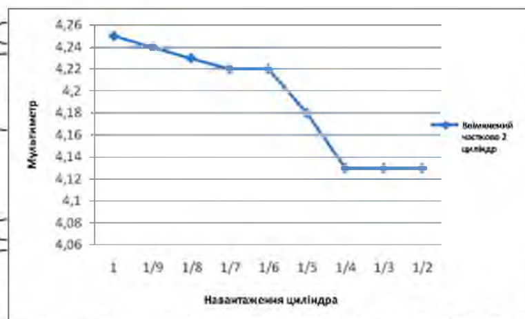
Рис. 4.24. Графік залежності мультиметра від навантаження циліндра при частково включеному другому циліндрі
