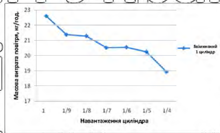
Рис. 4.10. Графік залежності - масова витрата повітря від навантаження циліндра при частково включеному першому циліндрі
