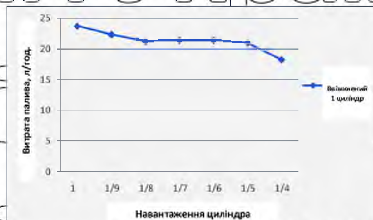
Рис. 4.11. Графік залежності витрати палива від навантаження циліндра при першому частково включеному циліндрі
