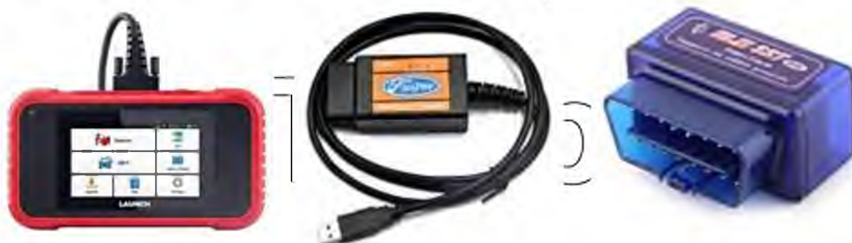
Рис. 1.3. Сканери автомобільної категорії МІ а) - з власним екраном; б) - з дротовим підключенням до ПК; в) - з Bluetooth передачею даних
