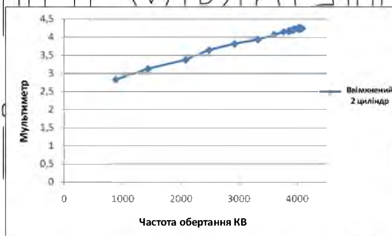
Рис. 4.20. Графік залежності мультиметра від частоти обертання КВ за другим включенням циліндра
