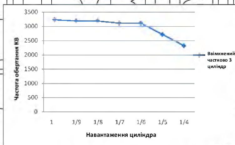
Рис. 4.33. Графік залежності частоти обертання КВ від навантаження циліндра при частково включеному третьому циліндрі
