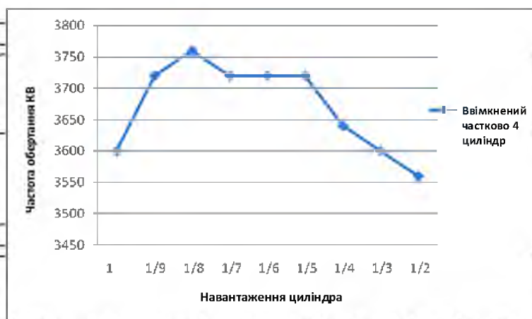
Рис. 4.45. Графік залежності частоти обертання КВ від навантаження циліндра при частково включеному четвертому циліндрі
