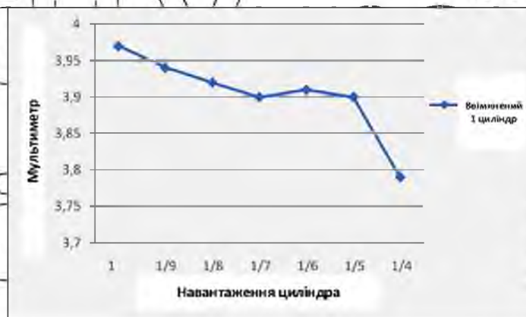
Рис. 4.12. Графік залежності мультиметра від навантаження циліндра при першому частково включеному циліндрі
