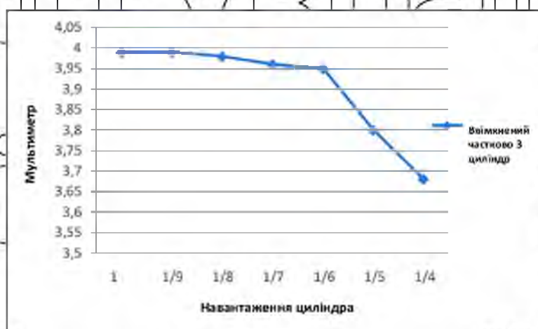
Рис. 4.36. Графік залежності мультиметра від навантаження циліндра при частково включеному третьому циліндрі
