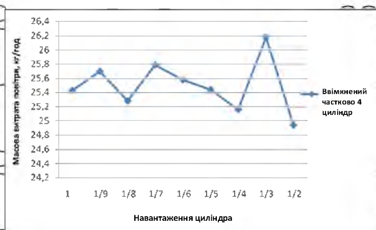
Рис. 4.46. Графік залежності масової витрати повітря від навантаження циліндра при частково включеному четвертому циліндрі
