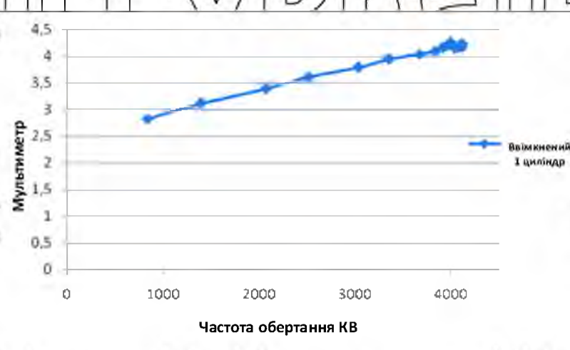
Рис. 4.8. Графік залежності витрат палива від частоти обертання КВ при першому включеному циліндрі
