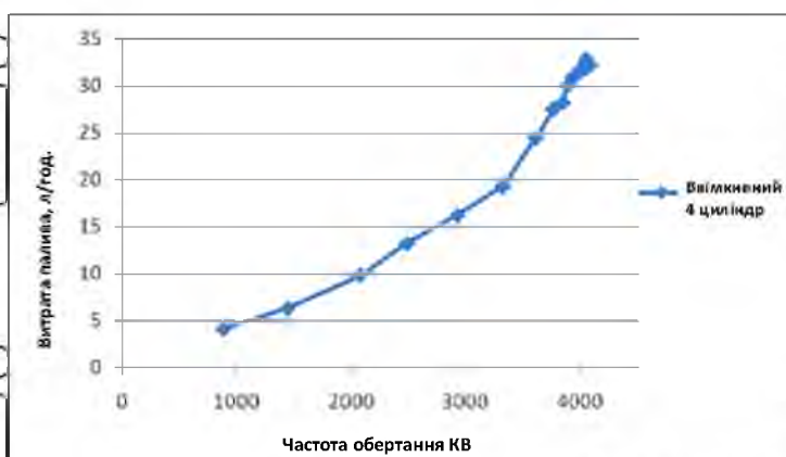
Рис. 4.43. Графік залежності витрат палива від частоти обертання КВ при четвертому включеному циліндрі
