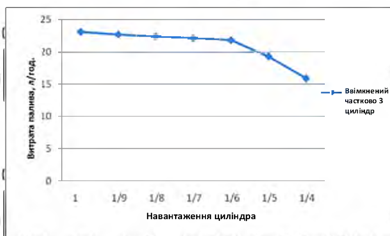
Рис. 4.34. Графік залежності масової витрати від навантаження циліндра при частково включеному третьому циліндрі
