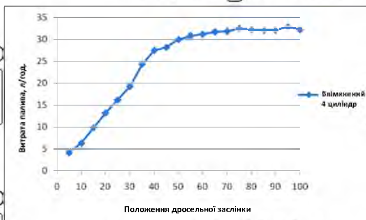
Рис. 4.39. Графік залежності витрати палива від положення дросельної заслінки при четвертому включеному циліндрі
