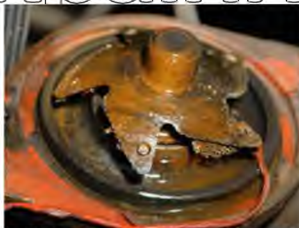
Рис. 1.4 - Кавітаційні руйнування гілки циліндрів двигуна автомобіля Renault при використанні антифризу низької якості
