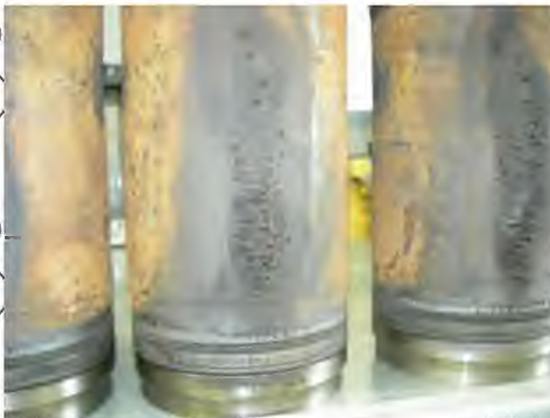
Рис. 1.4 - Кавітаційні руйнування гілки циліндрів двигуна автомобіля Renault при використанні антифризу низької якості
