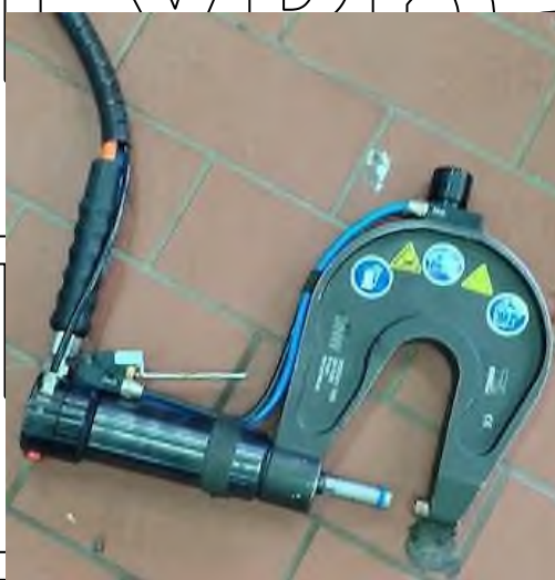
Рис. 4.2. Фото ручного заклепочника для встановлення пресових (самопробивних) заклепок
