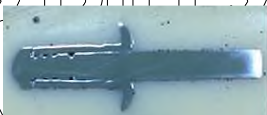
Рис. 4.3. Фото шліфів витяжних (а) та самопробивних (б) заклепок
