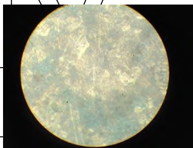
Рис. 4.4. Фото структури стрижня (а) та корпусу (б) витяжної та пресоаної (в) заклепки. Збільшення \times 1000 разів
