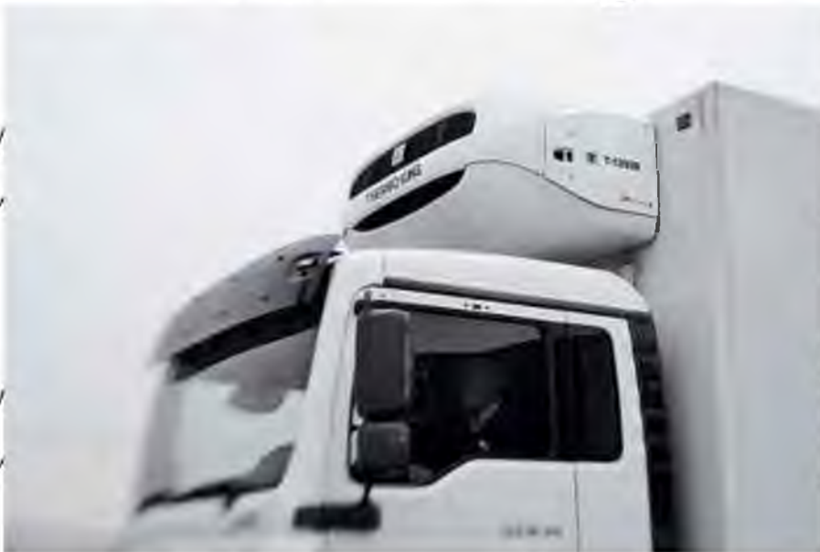
Рис. 2.2. Фронтальне розміщення устаткування рефрижератора.
