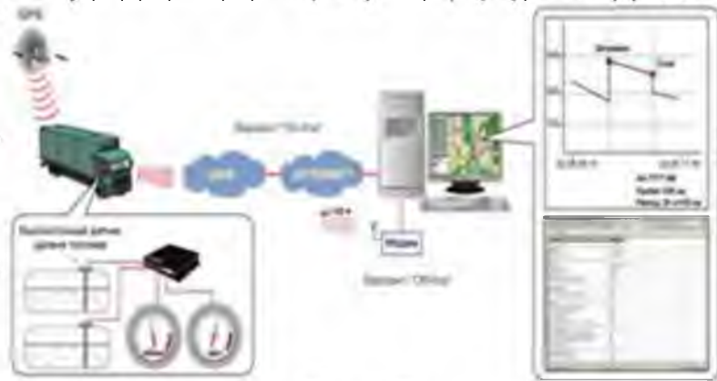
Рис. 2.9 - Схема застосування контролю витрат палива в системах GPS моніторингу
