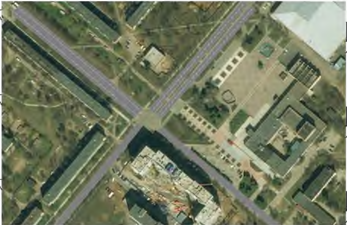
Рис. 3.4. Загальний вигляд прокладених доріг в програмі PTV Vissim
