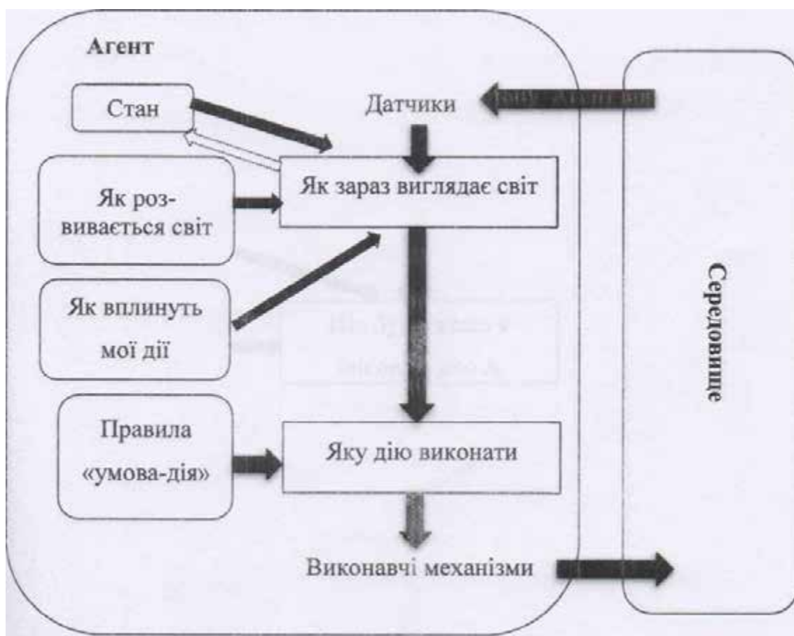
Рисунок 2.2 – Агент, що діє з врахуванням внутрішнього стану
