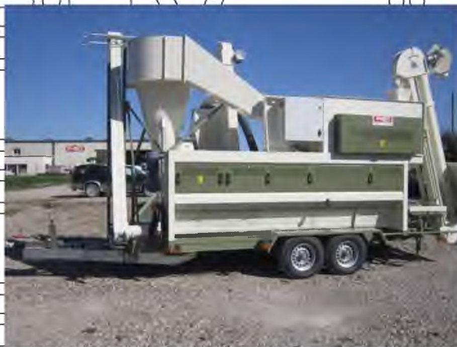
Рис. 1.7. Мобільний сортувально-протруювальний комплекс з пристроєм для очистки насіння Dorez RTB 354 (Франція).
