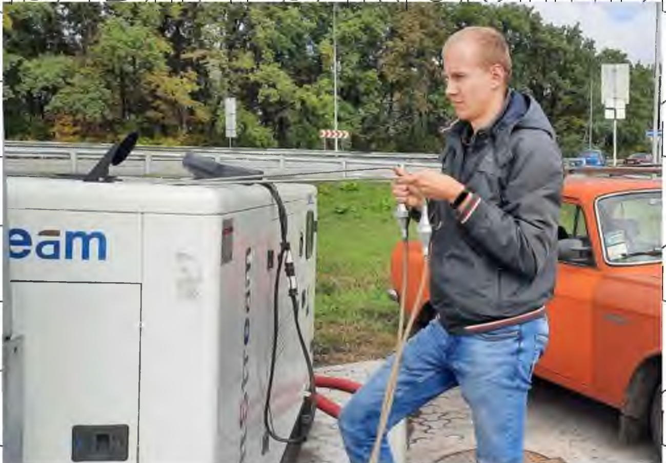
Рисунок 2.6 – Проведення вимірювань викидів ЗР від дизель-генератора на АЗК
