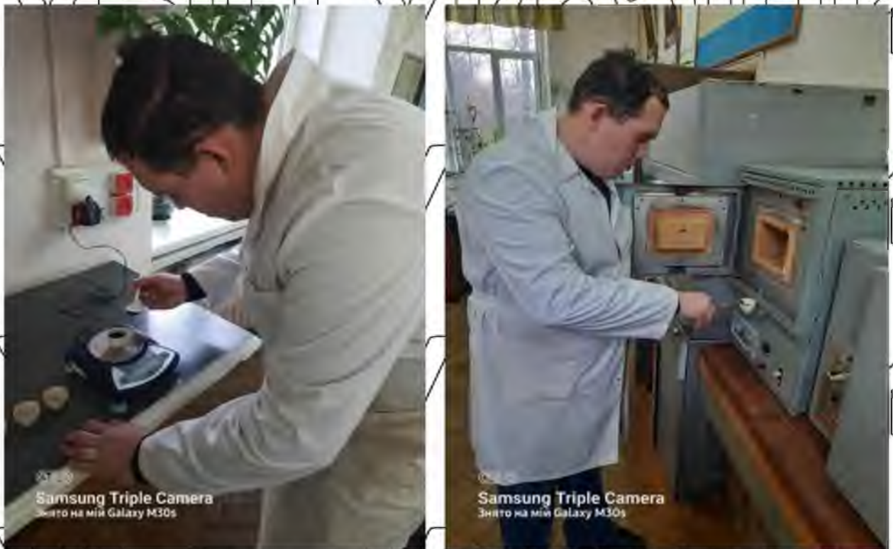
Рис. 3.5. Відбір навіжок торфового ґрунту та визначення його органічної речовини у муфельній печі
