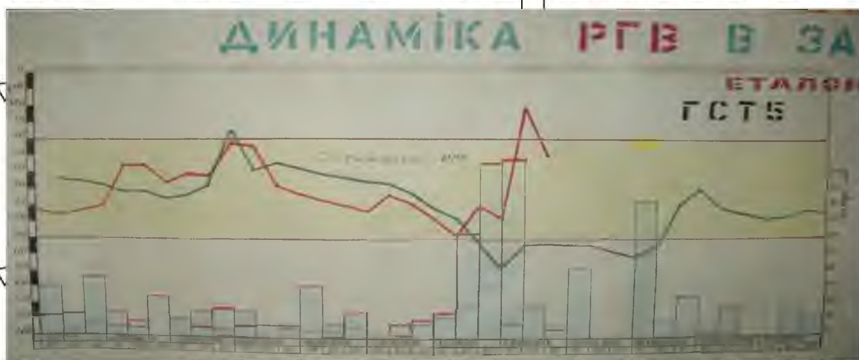
Рис. 3.1. Динаміка рівня ґрунтових вод Трубіжської осушувально-зволожувальної системи
