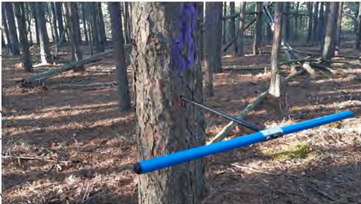
Рисунок 2.5. Відбір кернів за допомогою бурава Пресслера
