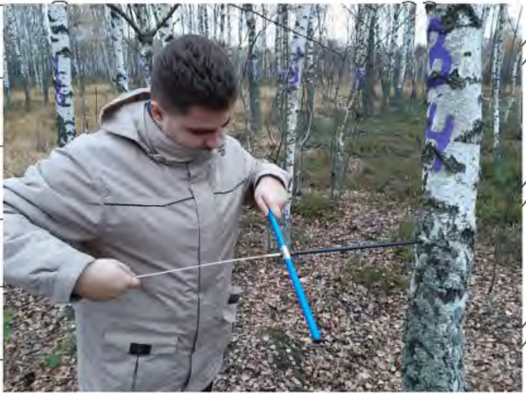
Рис. 2.4. Відбирання деревного керну за допомогою буру Haglöf
