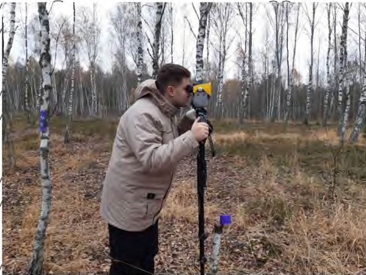
Рис. 2.6. Визначення висоти об'єктів за допомогою висотоміра Lazer Technology Inc., USA
