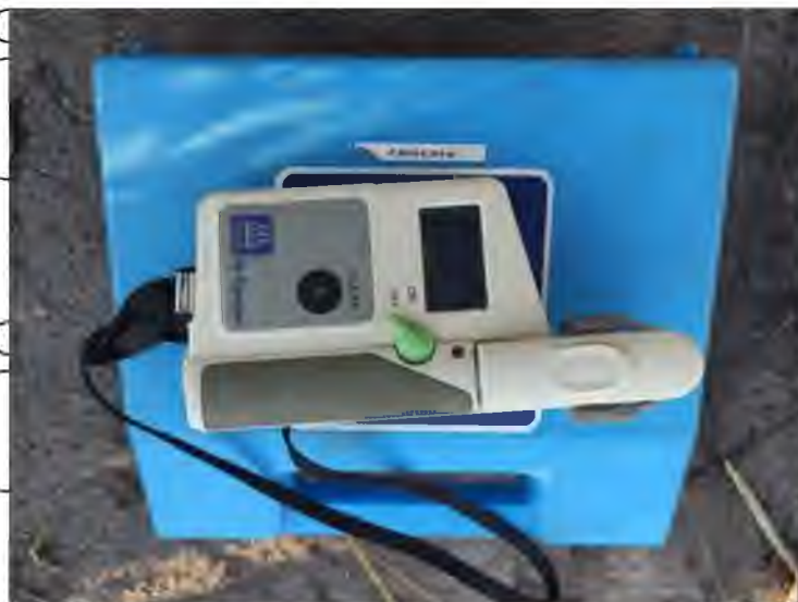
Рисунок 12. Портативний прилад Yara N-Тестер
