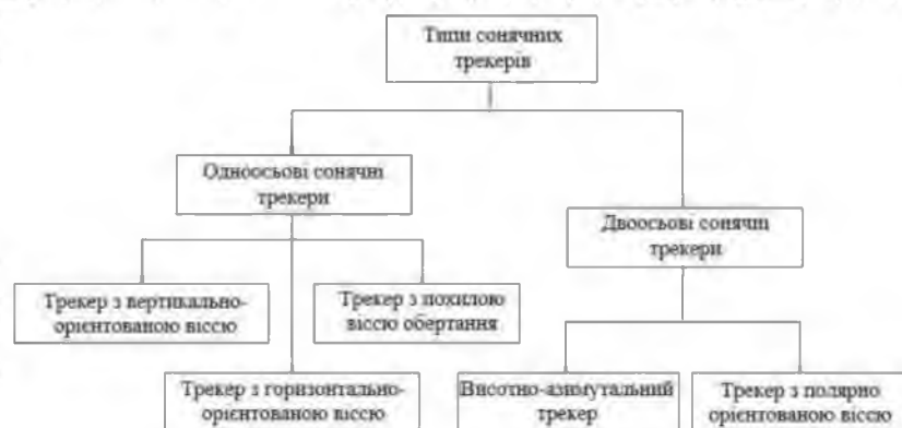
Рисунок 1.6 – Сонячні трекери: їх класифікація
