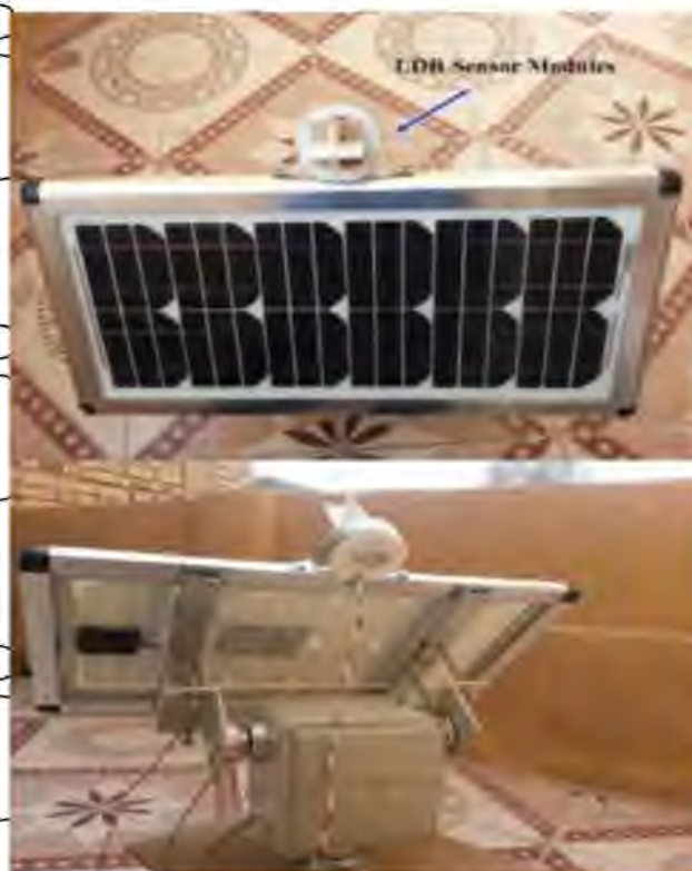
Рисунок 2.8 - Вигляд макету трекера із застосуванням фоторезисторів
