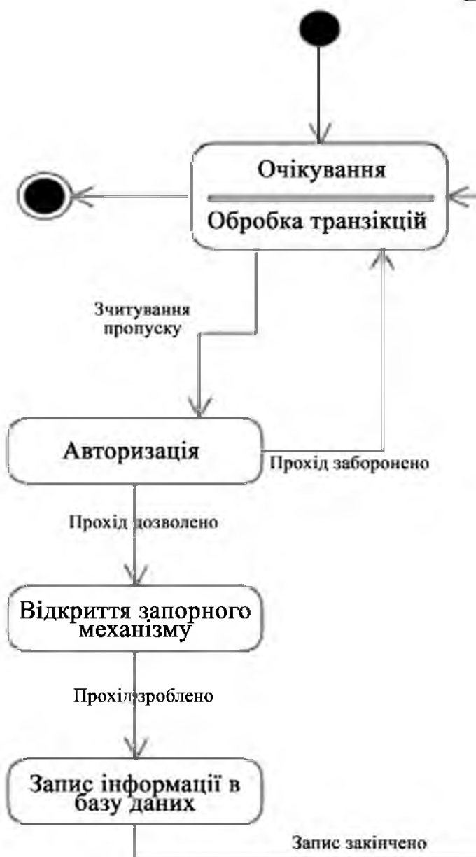
Рис. 2.2. Діаграма станів, де продемонстровано алгоритм роботи апаратної частини
