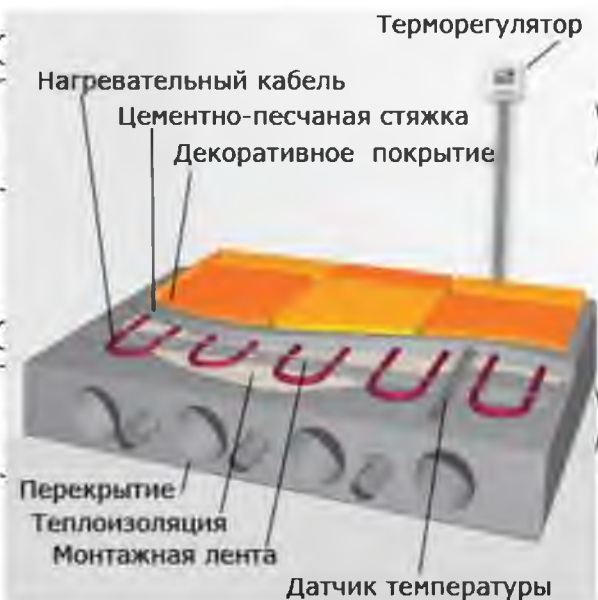
Рисунок 4.3. Влаштування теплої підлоги з гріючим кабелем.
