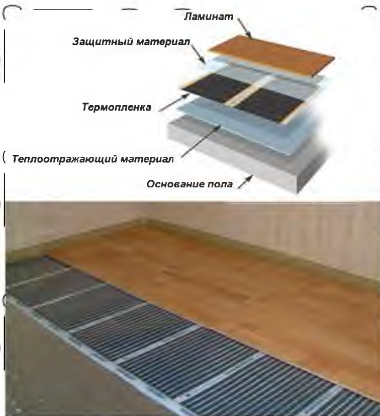
Рисунок 4.3.3 – Устройство тёплого пола с ИК-обогревом.
