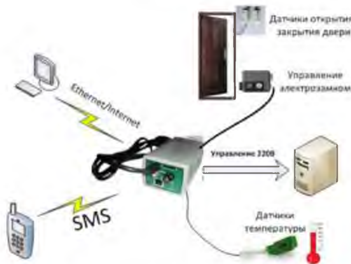
Рисунок 1.3- Загальна схема системи NetPing.
