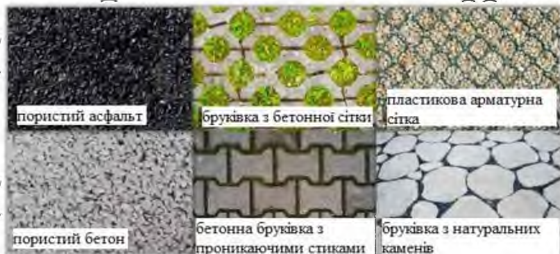
Рис. 3.8. Поширені проникні тротуари: пористий асфальт, бруківка з бетонної сітки, пластикова арматурна сітка, пористий бетон, бетонна бруківка з проникаючими стиками та бруківка з натуральних каменів [27]
