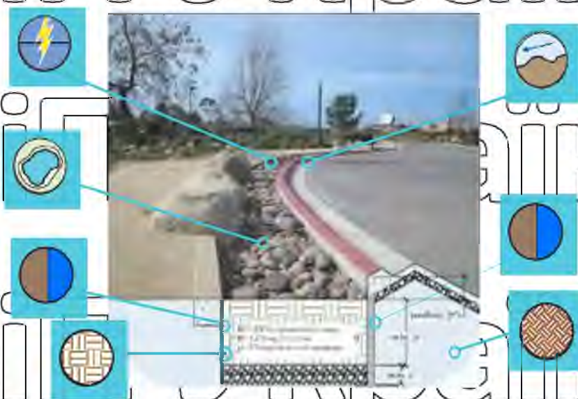
Рис. 3.6. Елементи інфільтраційної траншеї [24]
