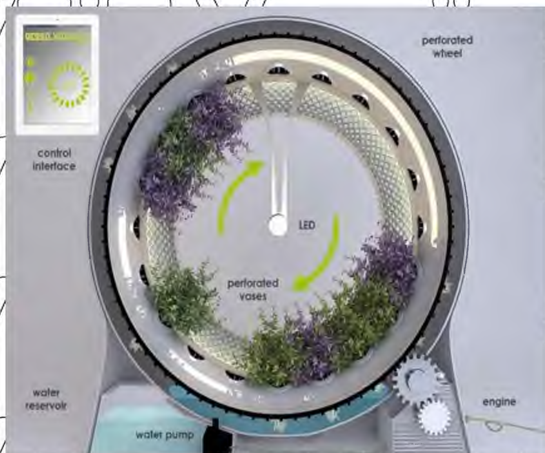
Рис. 3.5. Будова та принцип роботи гідропонної установки [20]
