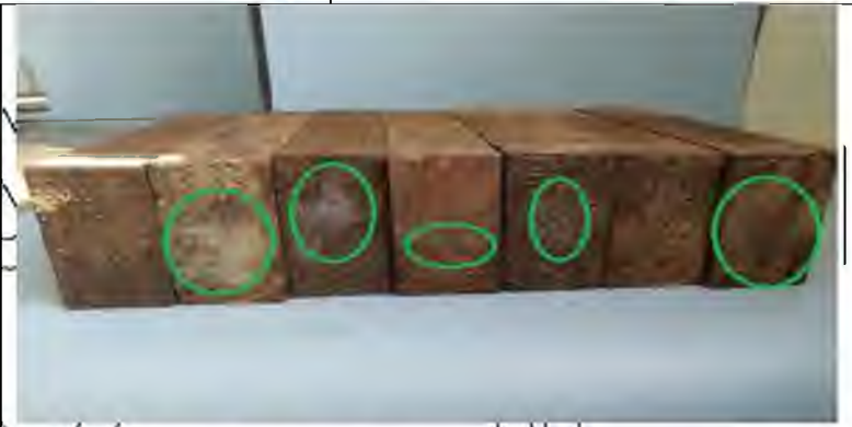
П'ять торців зразків були уражені пліснявою, два залишились в гарному стані
