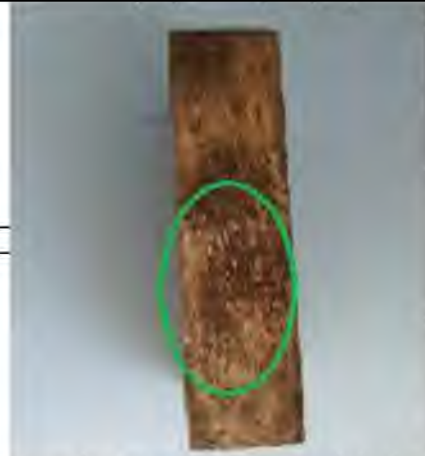
Зразок 2.1 покритися пліснявою та цвітлю
