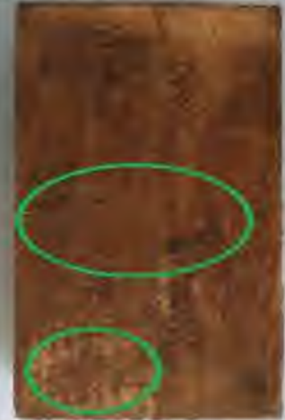
Зразок 3.3 покриття пліснявою з однієї сторони та синіми плямами
