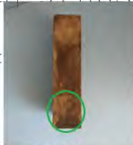
На зразку 1.2 з'явилась невелика ділянка зі швілю на його одній стороні
