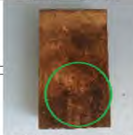
На двох сторонах зразка 2.4 з'явилась пліснява
