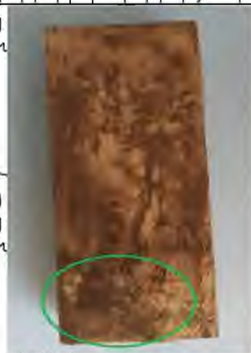
Зразок 1.3 покритися пліснявою з однієї сторони
