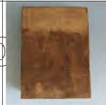
Зразок 1.6 не піддався гнилі, однак присутні сині плями
