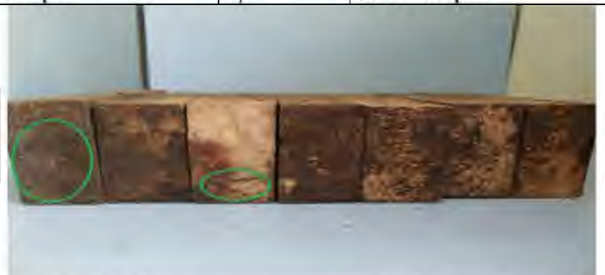
Два торці зразків були уражені пліснявою, п'ять залишилися в гарному стані
