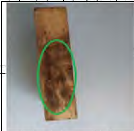
Зразок 1.1 покритися пліснявою з двох сторін
