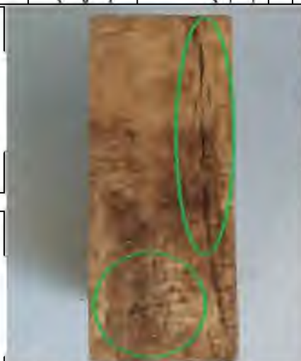
Зразок 1.1 покритися синявою з усіх сторін та з'явилась тріщина вздовж зразка
