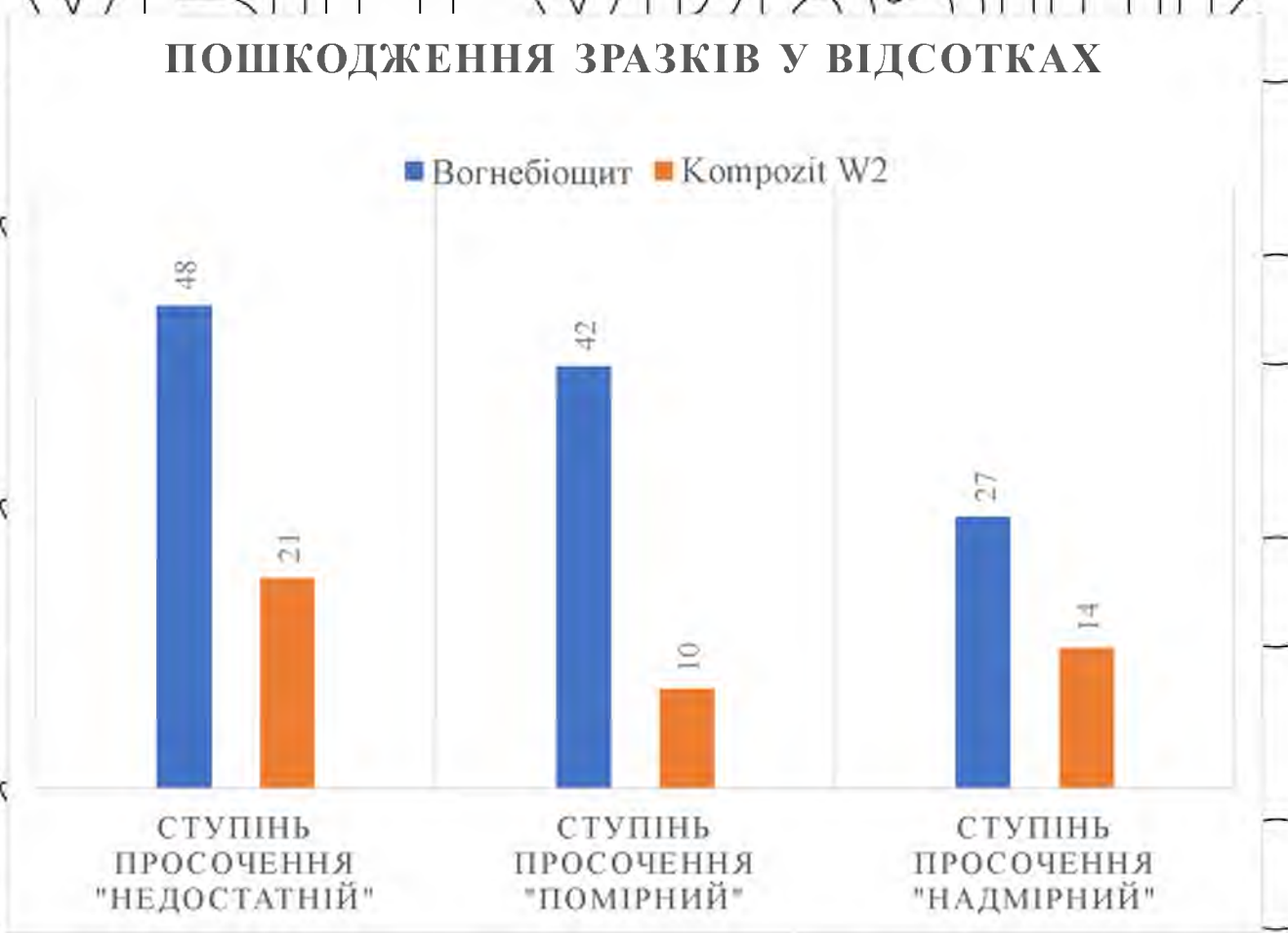
Рис 3.3. Результат ураження зразків із застосуванням різних антисептиків і ступенів просочення
