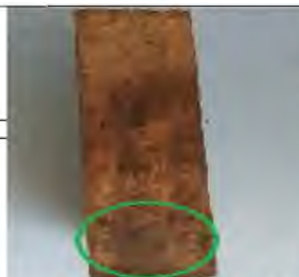
Зразок 2.7 був вражений синіми плямами з двох сторін
