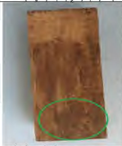
На зразку 1.2 з'являється невелика ділянка з синявою на його одній стороні
