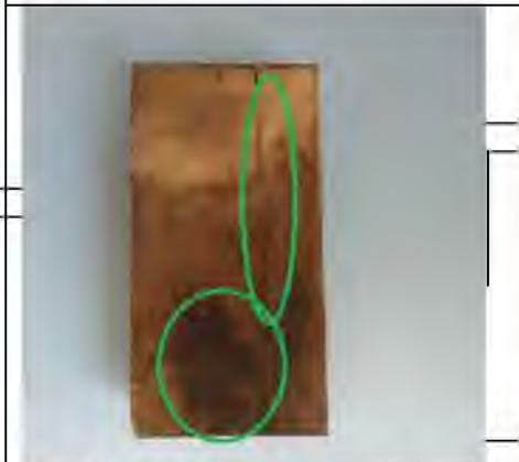
На одній стороні зразка 1.4 з'явилась пліснява та поздовжня тріщина
