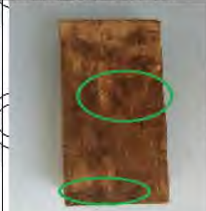
Зразок 2.6 був вражений пліснявою та синіми плямами з однієї сторони
