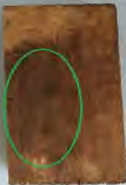
Зразок 3.7 був вражений синіми плямами з двох сторін
