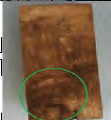
На одній стороні зразка 1.4 з'явилась пліснява
