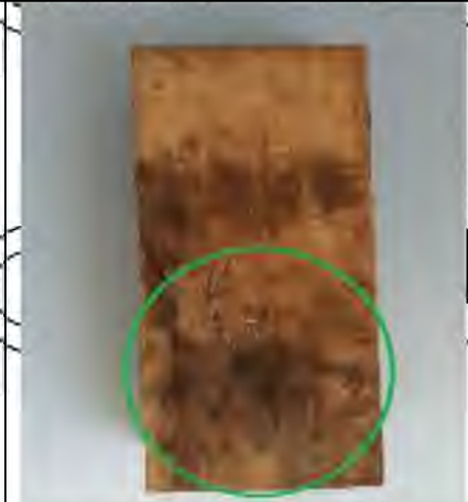
Зразок 2.3 покритися пліснявою та синіми плямами з усіх сторін
