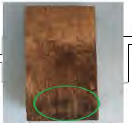
Зразок 1.7 покритися синіми плямами з двох сторін
