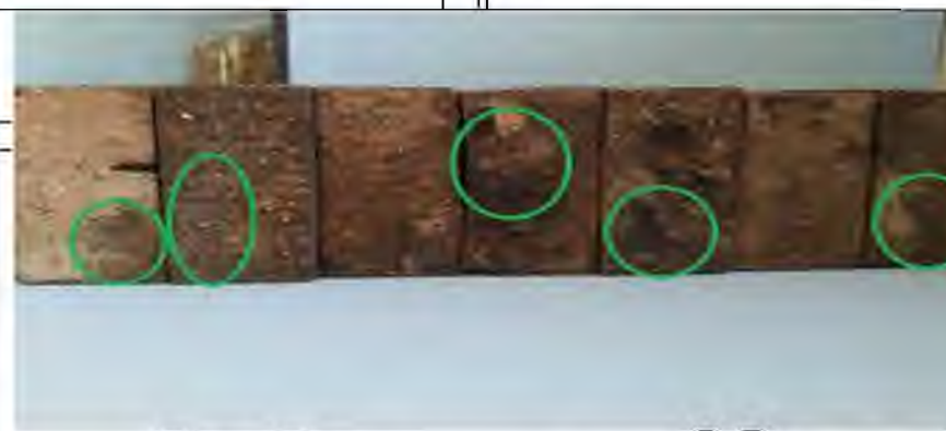
П'ять торців зразків були уражені пліснявою, два залишилися в гарному стані
