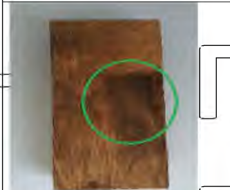
Зразок 1.7 покритися пліснявою та синіми плямами з усіх сторін
