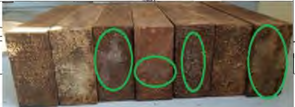
Чотири торці зразків були уражені пліснявою, три залишилися в гарному стані
