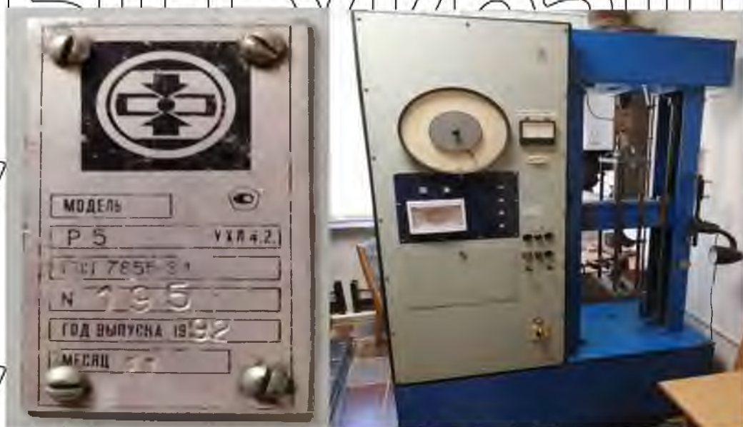
Рис. 3.3. Розривна машина Р-5
