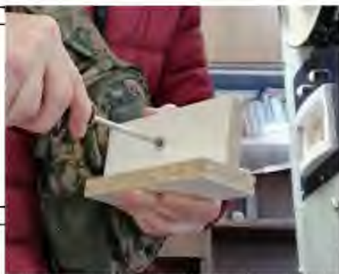
Рис.3.7 З'єднання зразка ДСП – ДСП Т-подібним способом
