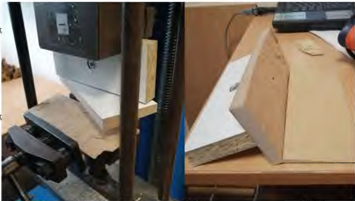
Рис.3.15 Розслоєний зразок МДФ
