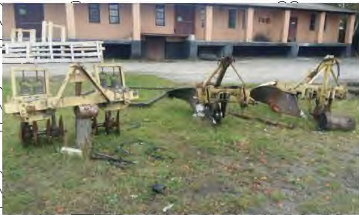
Рис 4.16. Розміщення протипожежних плугів ПКЛ-70 та БДН-1,7 біля лісової пожежної станції підприємства
