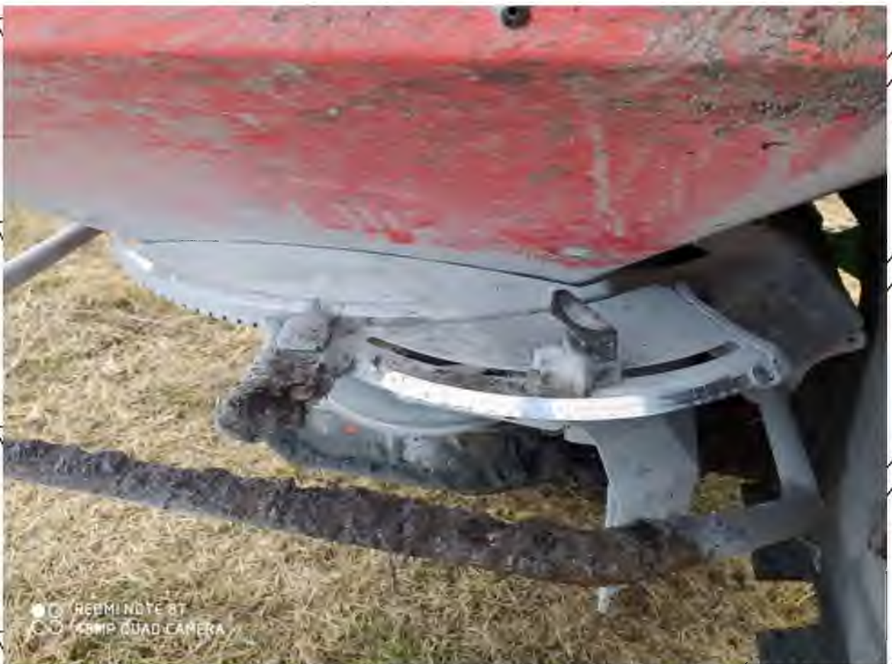
Рис. 3.3 система регулювання витрат добрив кг/га .
