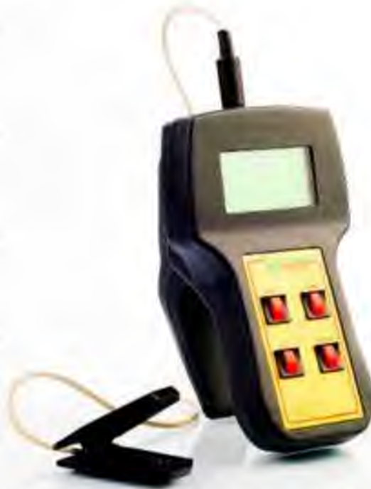
Рисунок 1.5. Портативний прилад для експрес-діагностики стану рослин "Флоратест" (Інститут кібернетики НАН України) [1]
