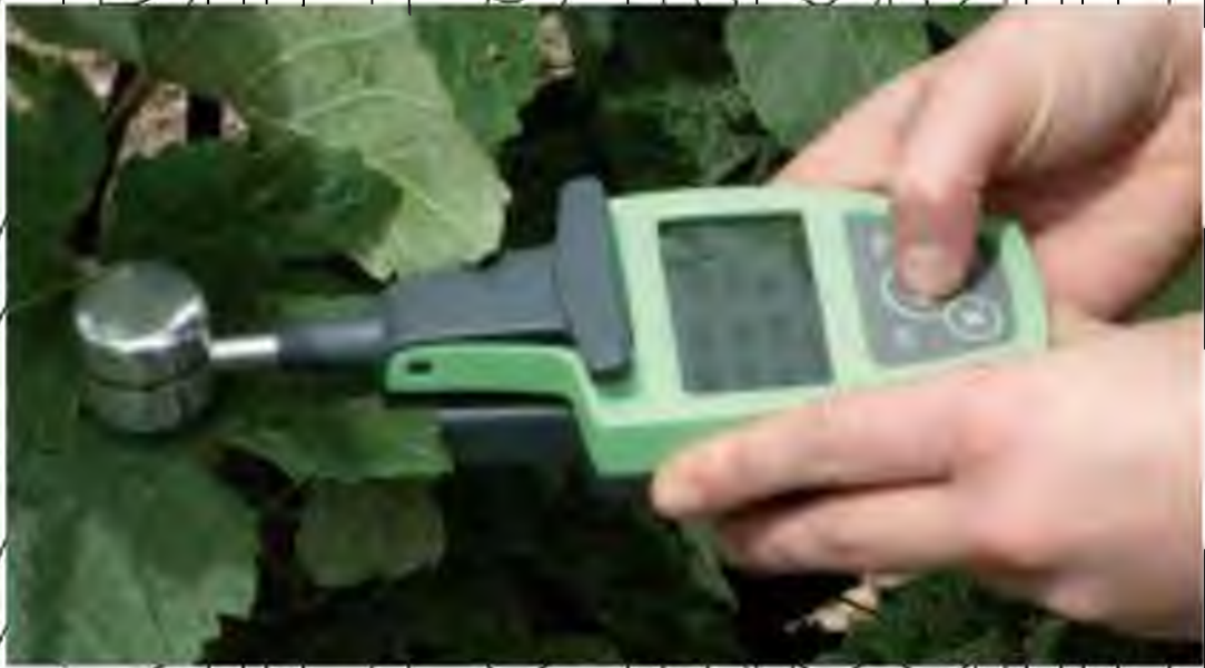
Рисунок 1.4. DUALEX SCIENTIFIC+™ (компанія FORCE-A (Франція)) [1]
