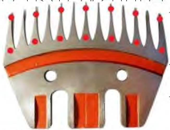
Рис. 3.4 Крапки виміру твердості робочих поверхонь ножів і гребінки
