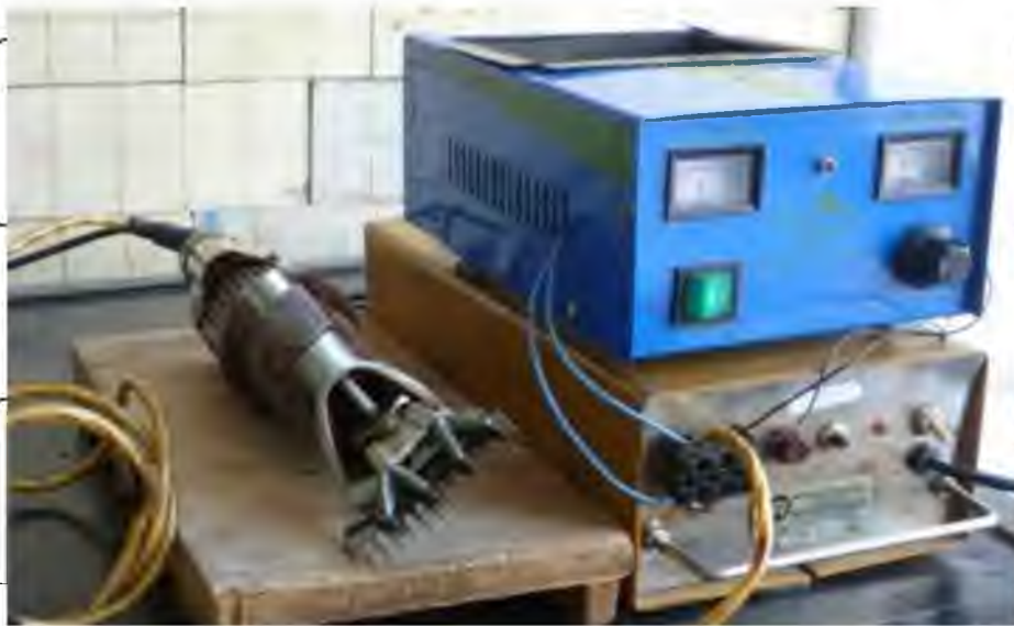
Рис 3.11 - Модифікація стенда для ускореного проведення испытаний качества заточки (Ю.А. Хлопко). Машинка МСУ-200.
