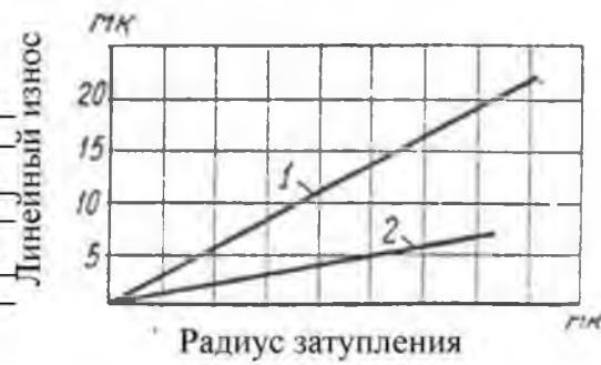
Рис. 1.12 - Залежність між лінійним зношуванням і радіусом затуплення лез ножа 1 і гребінки 2 (по П.К. Григорову)
