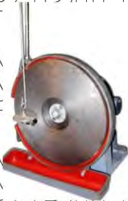
Рис. 1.8- Точильний апарат ТА-1. Ешора швидкостей диска при заточенні ножа на дисковому апараті
