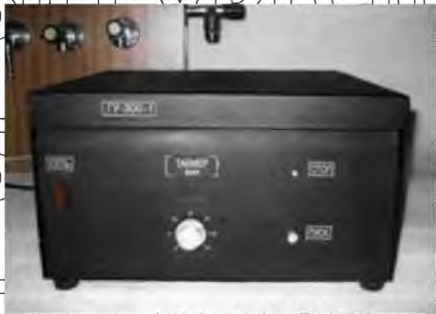
Рисунок 3.3 - Ультразвуковий генератор ТУ-300-1
