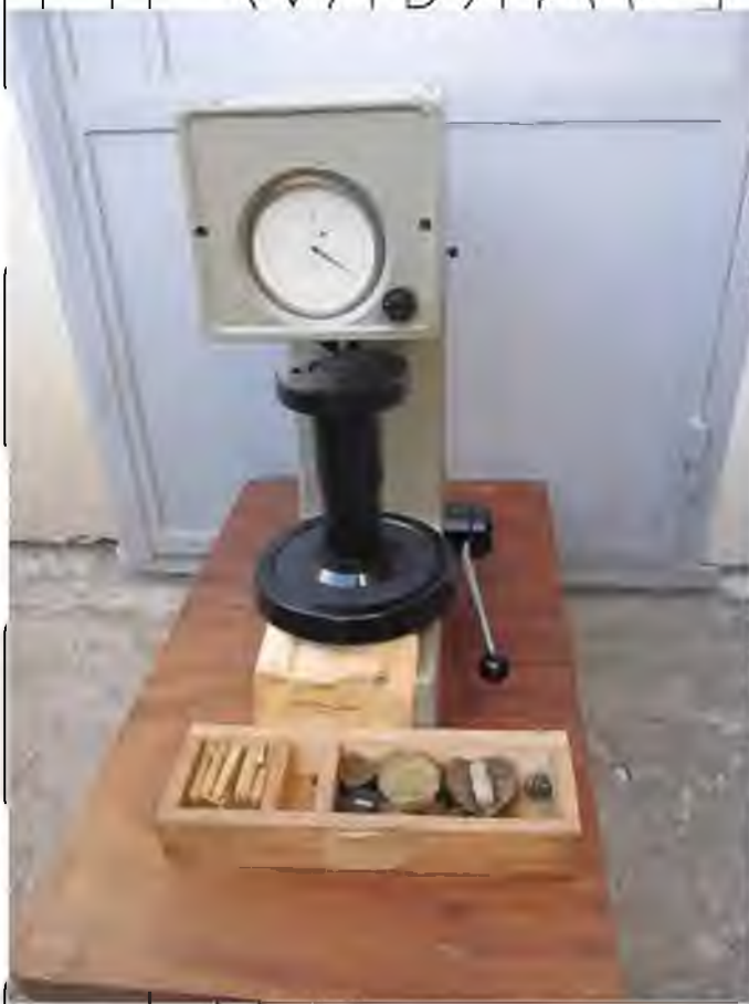
Рисунок 3.6 – Загальний вид модернізованого твердоміра типу ТП
