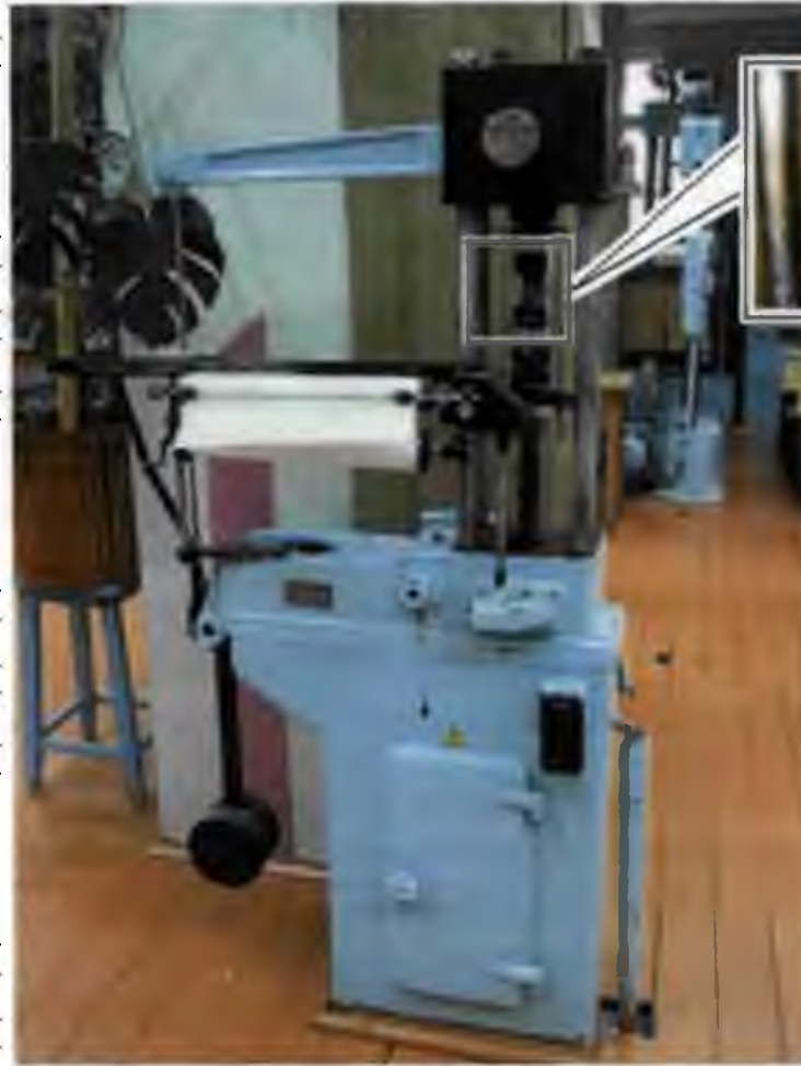
Рисунок 3.13 – Випробувальна розривна машина ІМ-4Р
