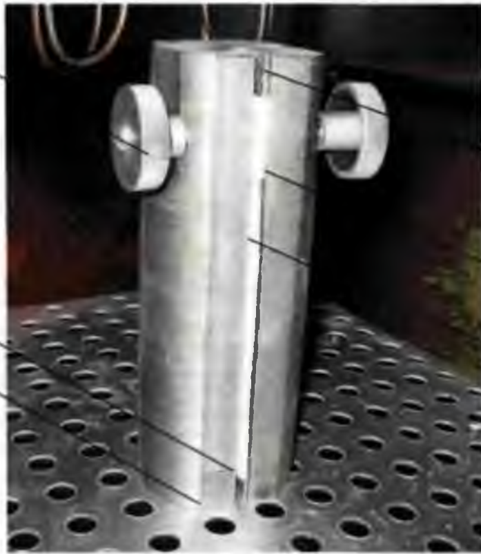
Рисунок 3.11 – Загальний вид пристосування визначення коефіцієнта теплового розширення (КТР):
