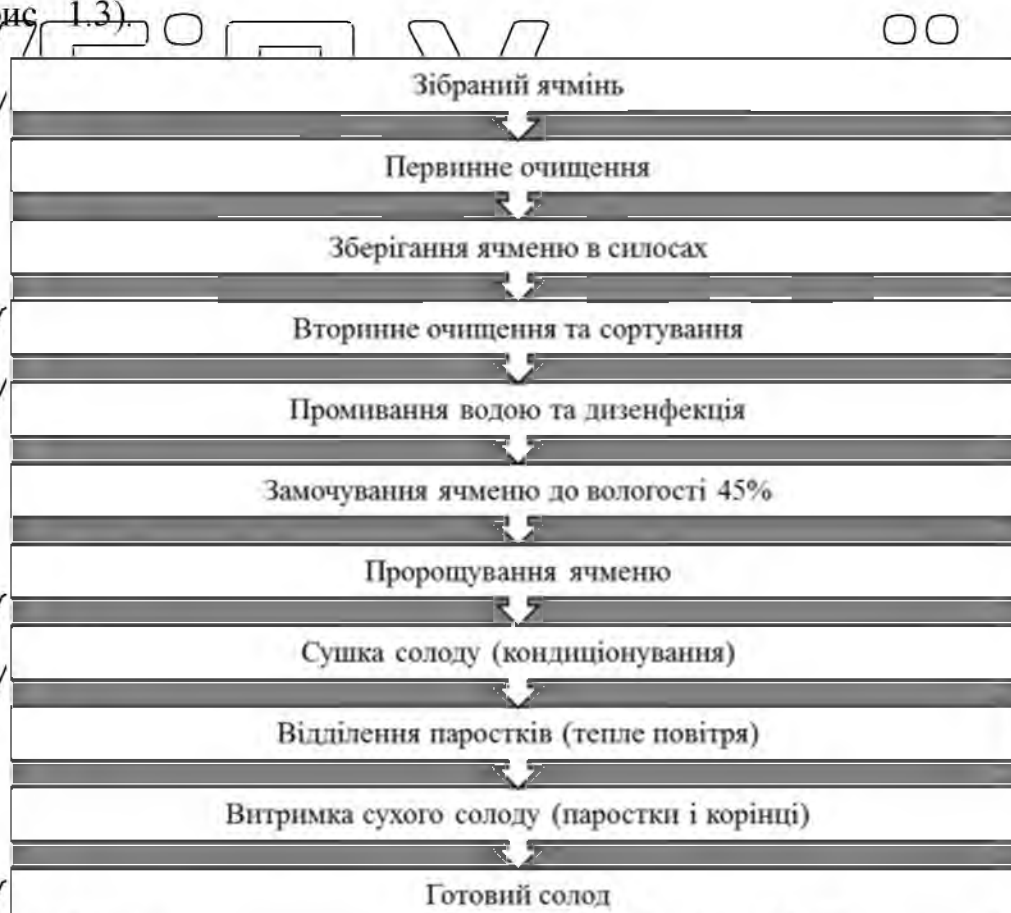
Рис. 1.3. Технологічна схема виробництва солоду
