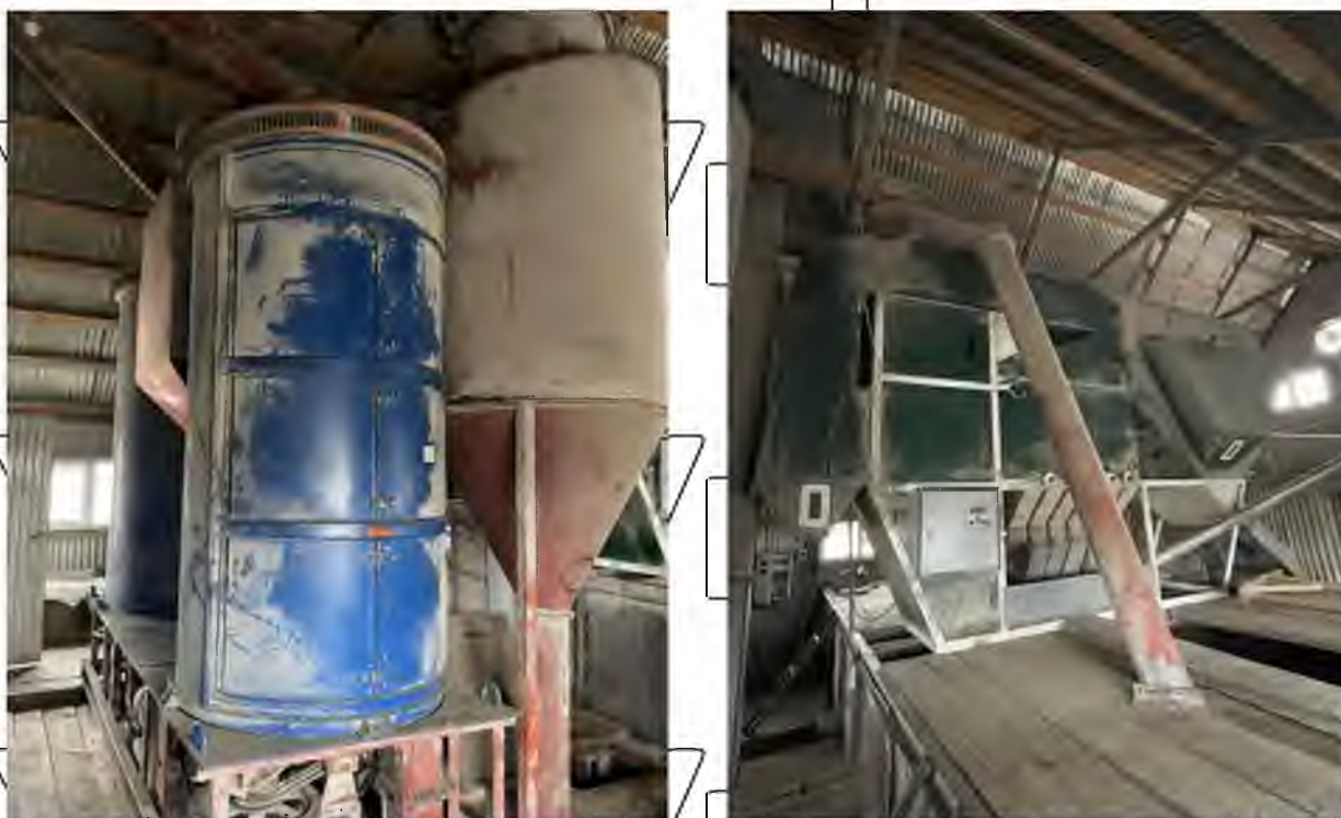
Рис. 2.2. Зерноочисні машини, що використовували для очищення зерна у СВК «Зоря»: А – БЦС-50; Б – САД-50
