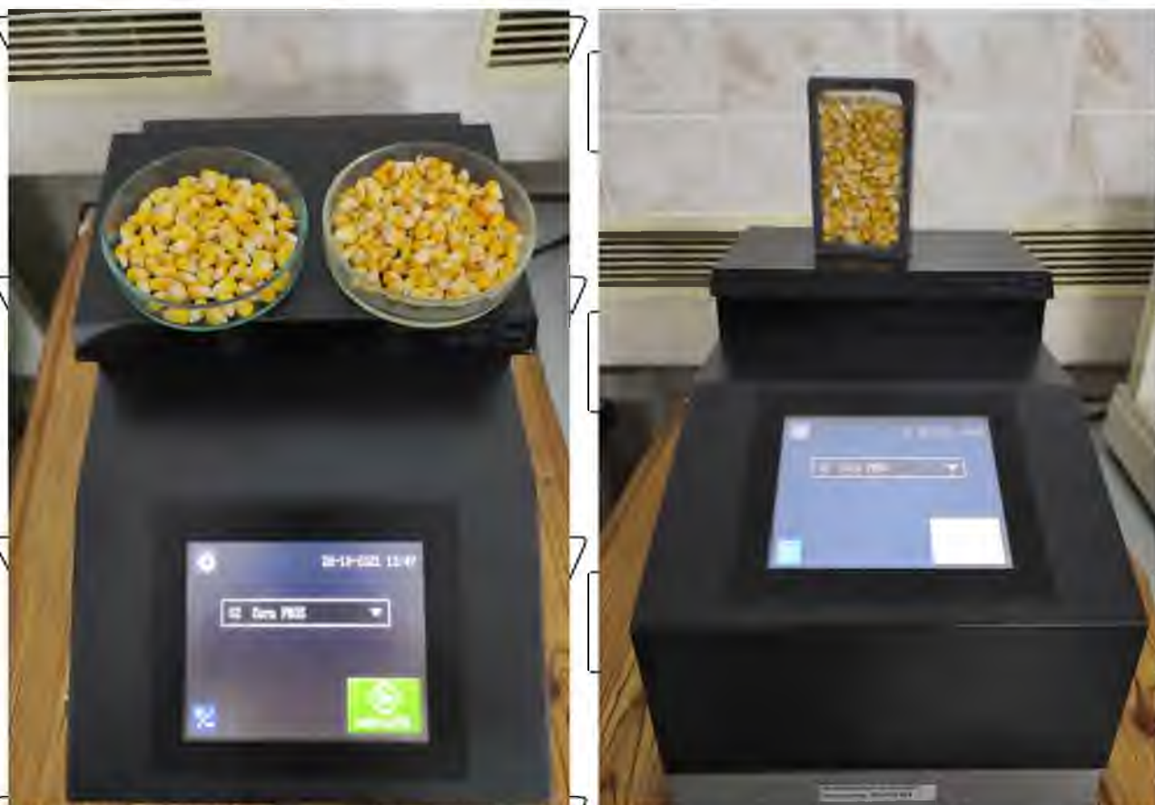
Рис. 2.5. Інфрачервоний аналізатор Kett AN-920 для визначення біохімічних показників якості зерна
