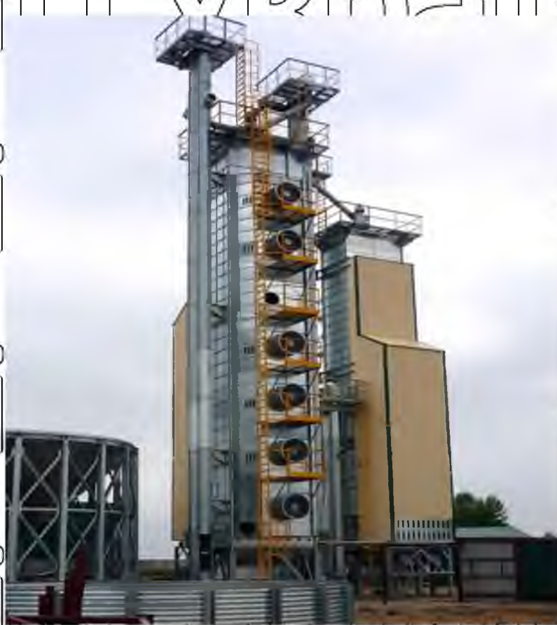
Рис. 1.3. Прямоточна шахтна сушарка Vesta для сушіння зерна кукурудзи
