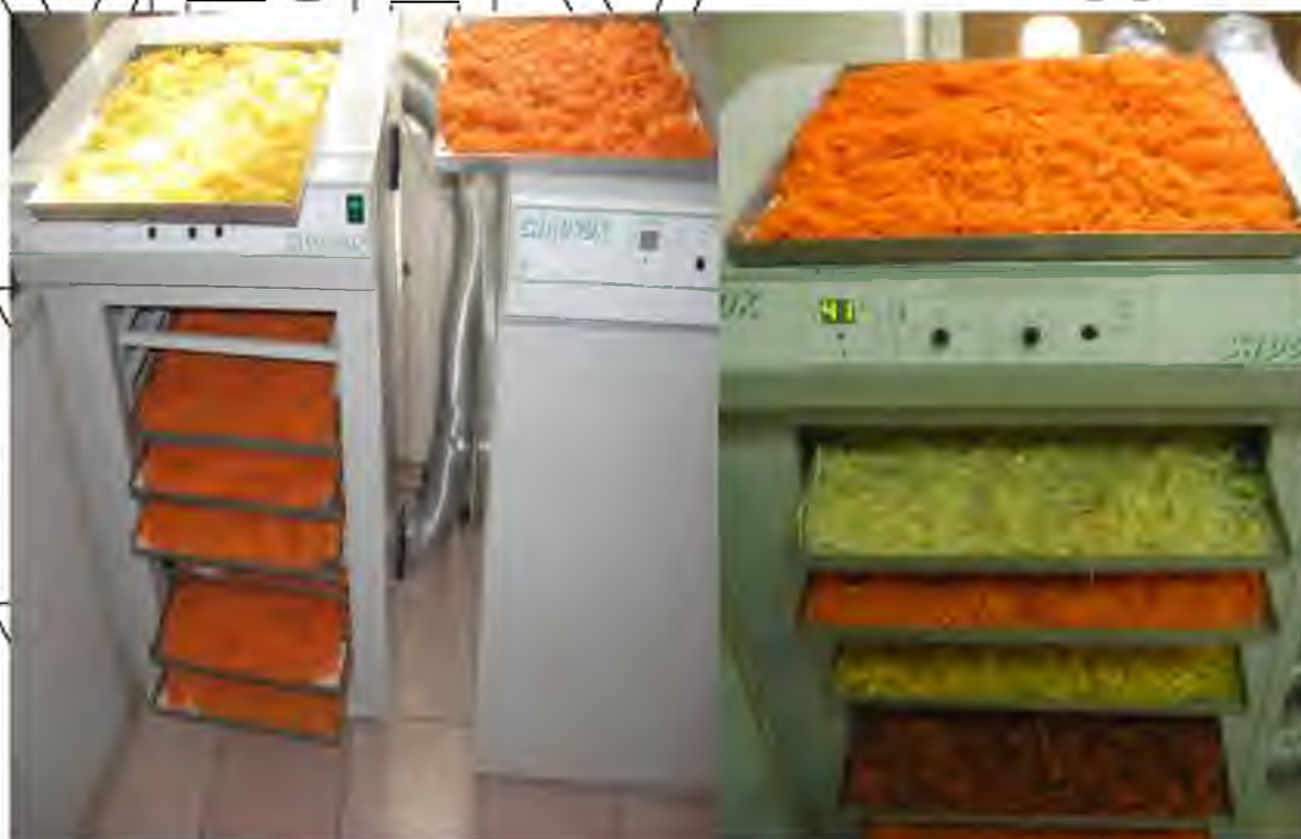
Рис. 2.1. Конвективна сушарка «Садочок – 2 М» камерного типу, використана у дослідженнях
