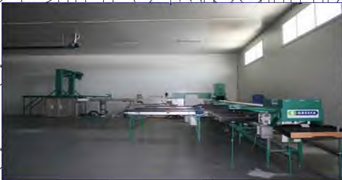
Рис. 1.4. Механізована лінія для проведення післязбиральної доробки та підготовки овочів до реалізації, зберігання чи переробки
