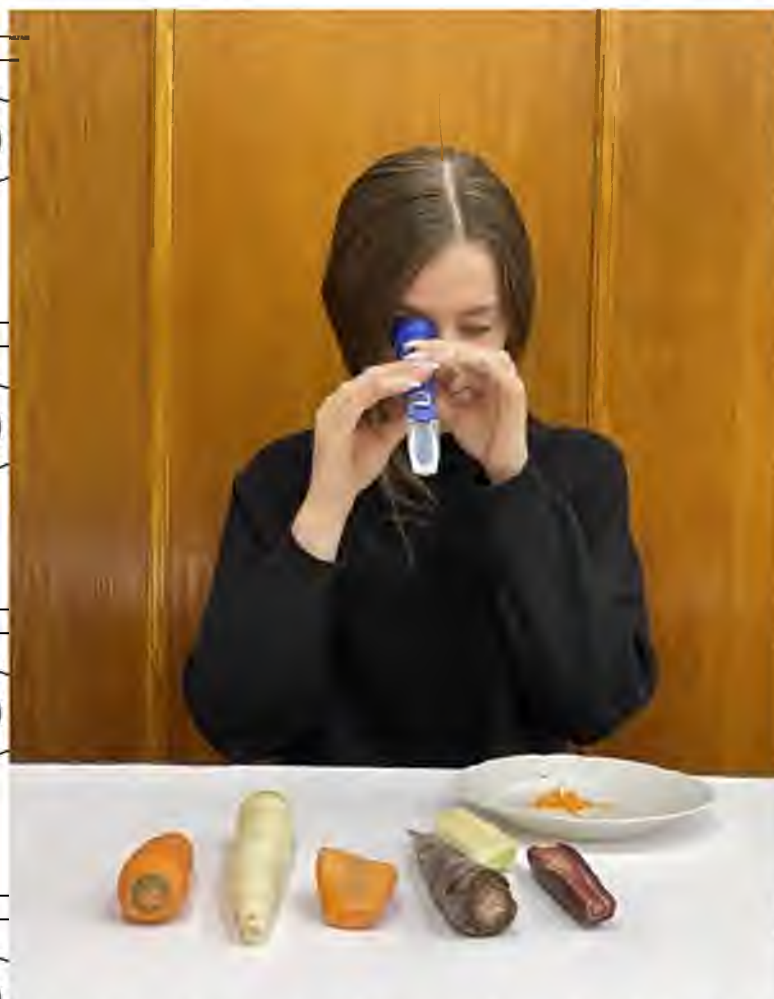
Рис.2.2. Визначення вмісту сухої розчинної речовини за допомогою рефрактометра
