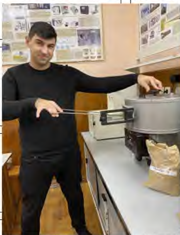
Рис. 2.2. Визначення вологості зерна рису досліджуваних сортів на приладі СЕШ-3М
