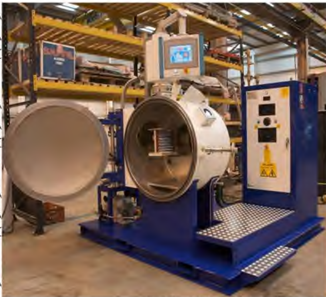
Рис. 1.1. Вакуумна індукційна піч
