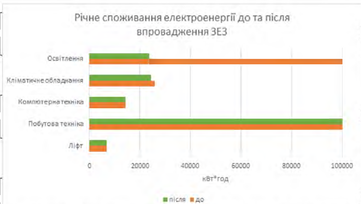
Рисунок 2.9 Річне споживання електроенергії до та після впровадження ЗЕЗ
