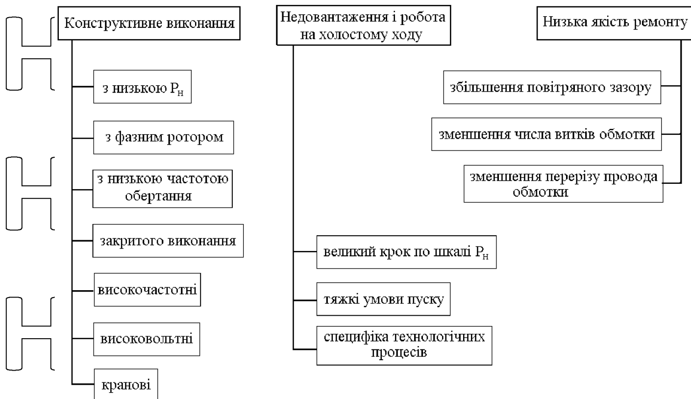
Рис. 3.2 Причини підвищеного споживання реактивної потужності асинхронними двигунами
