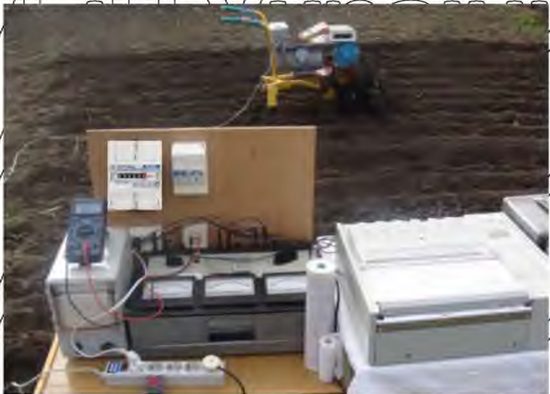
Рисунок 4.6 - Польові випробування блоку електродвигуна
