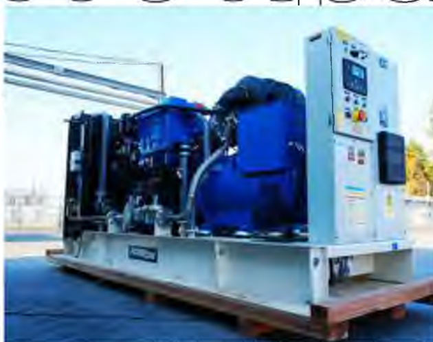
Рис.4.5 Газопоршнева установка PowerLink GR16S-NG (загальний вигляд)
