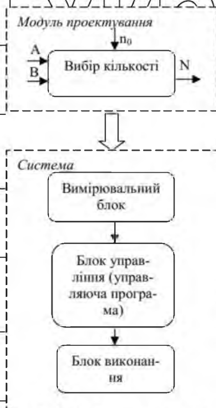
Рис. 1.1 Функціональна структура автоматичної системи контролю мікроклімату
