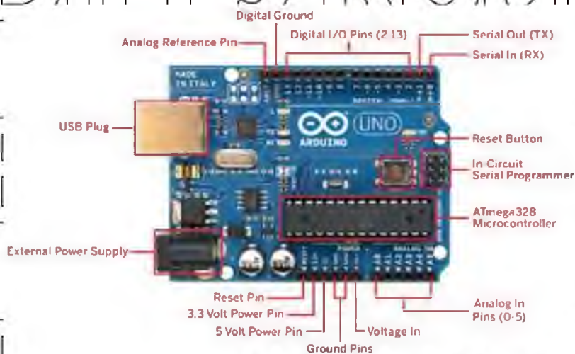
Рис. 2.2 – Загальний вигляд контролера Arduino Uno
