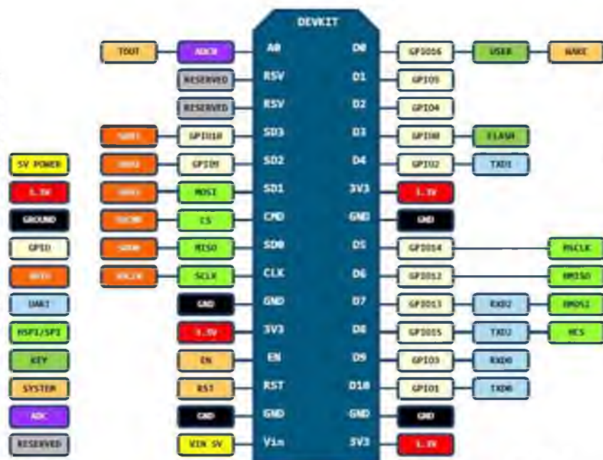
Рис. 2.7 – Розпіновка та логічне значення виводів ESP 8266 NodeMCU.
