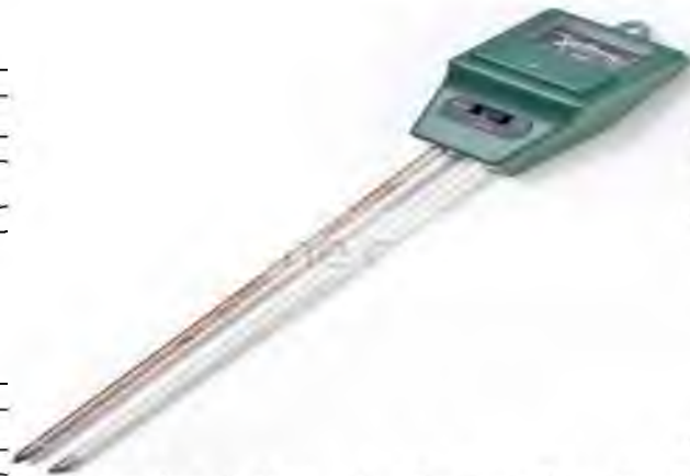
Рис. 1.4. Мультиметр ETP-301 для вимірювання освітленості, температури та вологості ґрунту.
