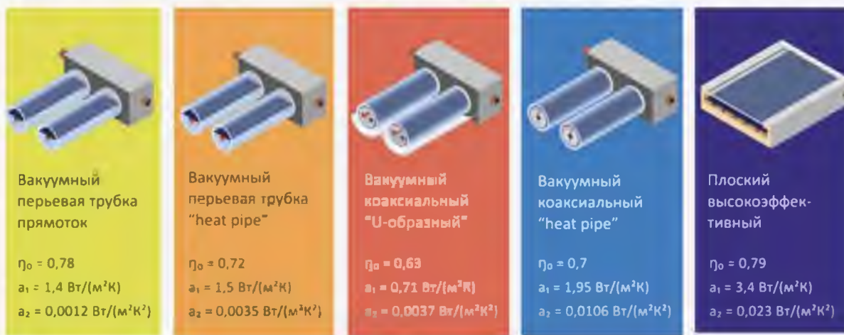
Рис. 4.1. Види сонячних колекторів та їх основні характеристики
